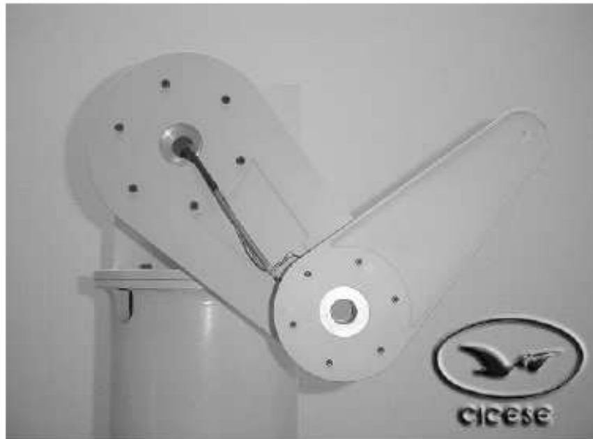
Fig. 10: Exemplo de robô manipulador dois graus de liberdade [CICESE, Robotics lab.]
